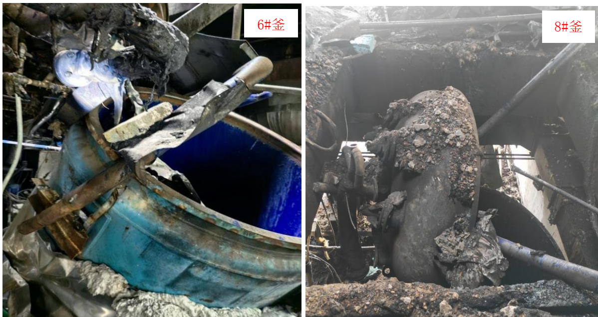
图 12 爆炸后的 6#釜和 8#釜
