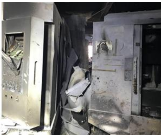
图6 飞落至两台五轴打磨机中间夹缝处的机械手打磨机外罩盖板
