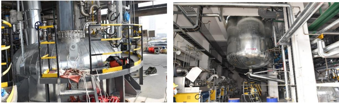
图 5 事故反应釜上部外观（左图）和下部外观（右图）
