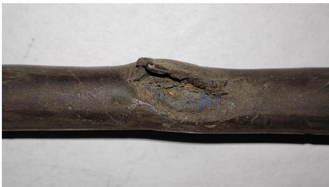
图 11 黄色三插位插座连接电缆线铜线裸露处
