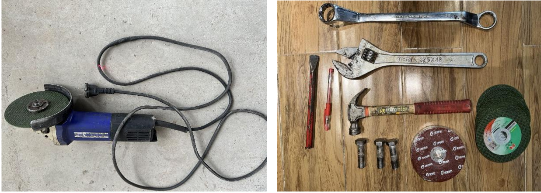
图 12 事故反应釜内取出的角向磨光机和其他物品
