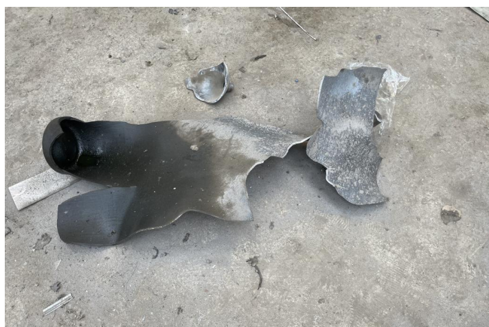
图 2 现场炸坏的氩气瓶
