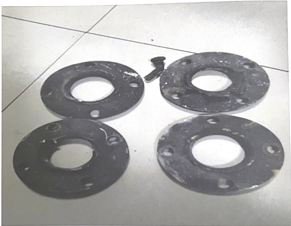
图 4 两对法兰连接管道断裂
