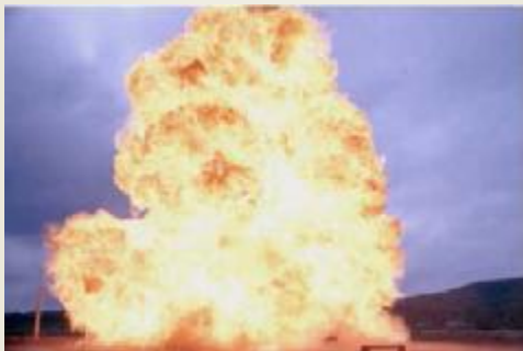
Fireball from propane BLEVE experiment. ii
