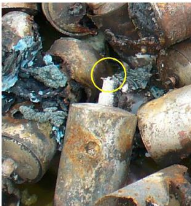
图 3 有激活针圈的氧气发生器
