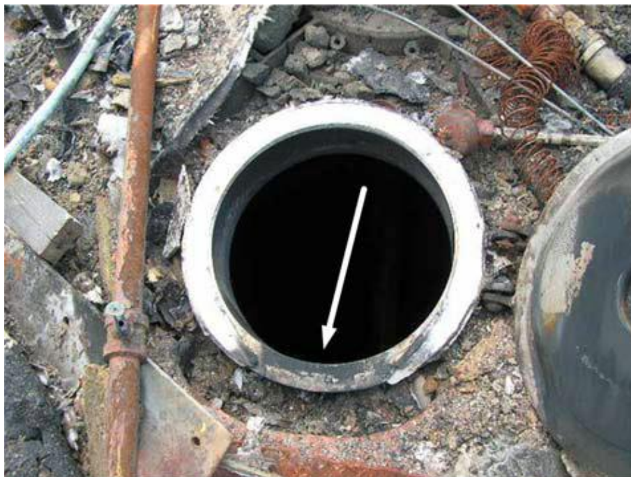
图 5 人孔垫圈处显示的蒸汽泄漏路径
