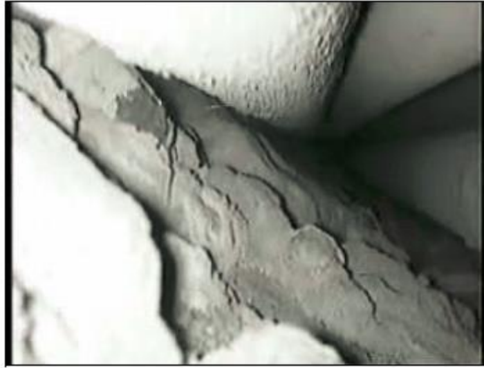
图 6 M1 反应器冷凝器水侧的积垢情况
