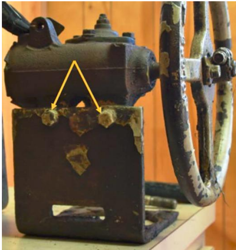
图 5：事故涉及的旋塞阀的齿轮箱支架实图
